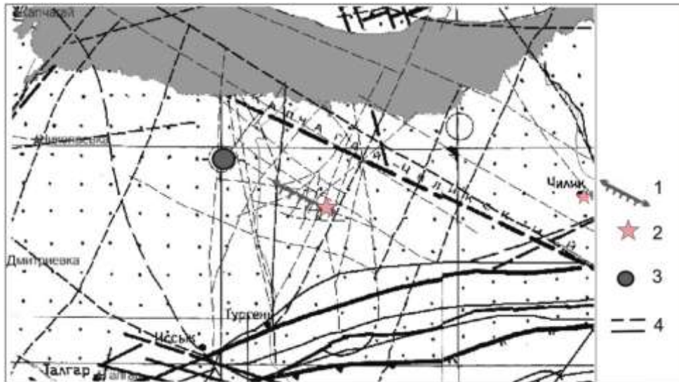
Рис. 10. К интерпретации положения плоскостей разрывов NP1 , NP2 в очаге Капчагайского землетрясения 1 мая 2011 г. с M_w=5.2
