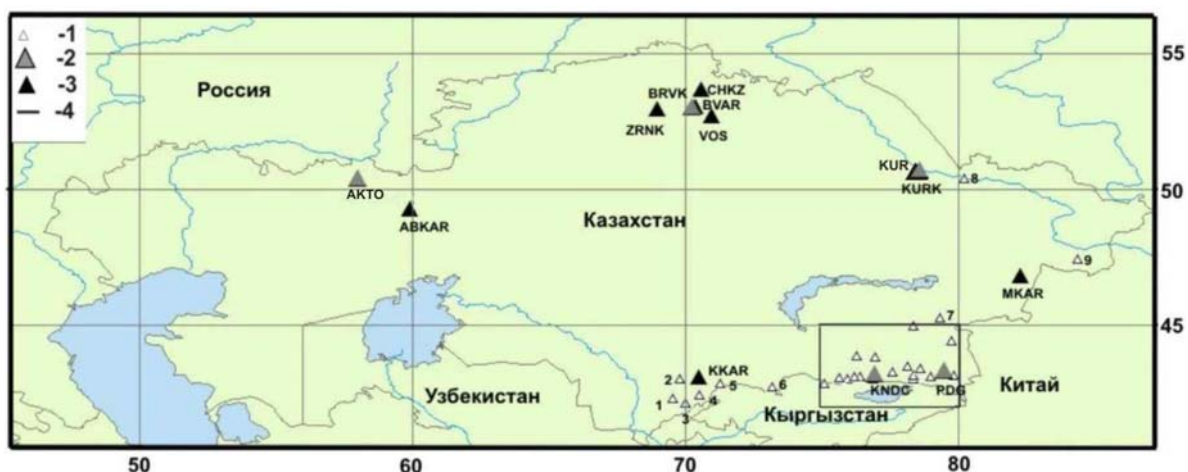
Рис. 1. Схема размещения сейсмических станций на территории Казахстана
