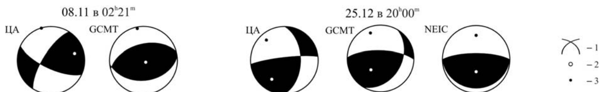
Рис. 3. Стереогаммы механизмов очагов землетрясений 8 ноября в 02^h21^m с K_p=12.4 , M_w=4.8 и 25 декабря в 20^h00^m с K_p=14.2 , M_w=5.8 в проекции нижней полусферы
