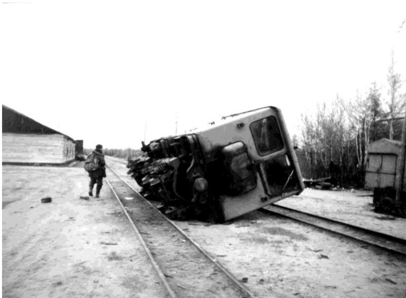
**Фото 5.** Ж/д станция "Нефтегорск": локомотив во время землетрясения опрокинулся в юго-восточном направлении.
