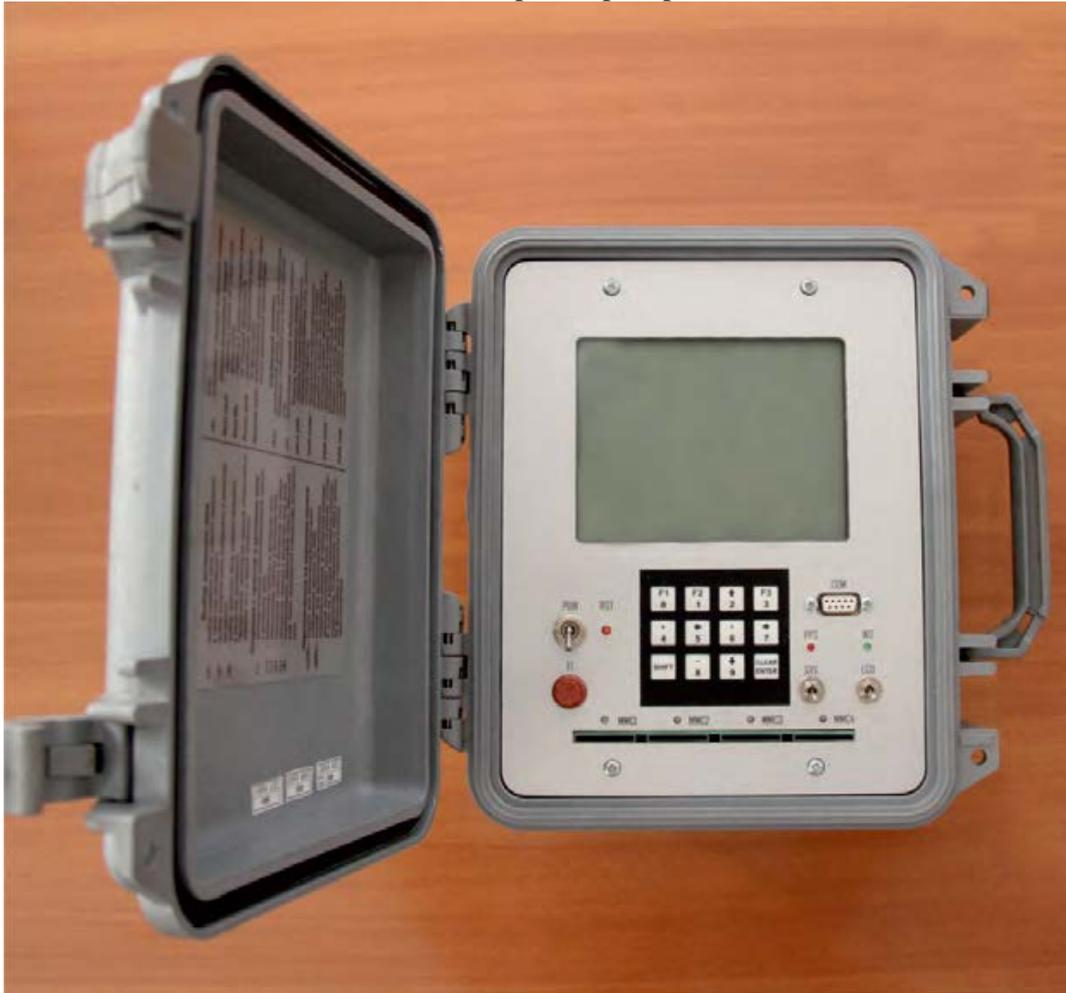
Регистратор имеет 24-разрядный АЦП и предназначен для оснащения как стационарных, так и временных пунктов наблюдения. Он обеспечивает запись сигналов в широком диапазоне частот с диапазоном усилений до 256, что в совокупности с высоким входным сопротивлением обеспечивает возможность использования практически любого сейсмического датчика.
