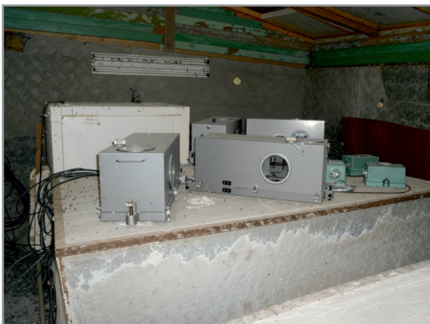
Рис. 4. Сейсμοприёмники СКД и СМ-3КВ (слева направо) на бетонном постаменте в сейсмической лаборатории, 2005 г.
