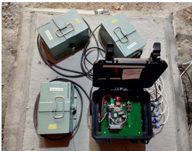
Рис. 9. Сейсмоприёмники SM-3KB и регистратор UGRA на постаменте, 2023 г.
