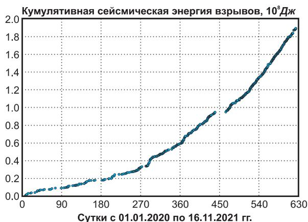
Рис. 12. Кумулятивная сейсмическая энергия, высвобожденная при взрывах в пределах карьера «Центральный» за 2020–2021 гг.
