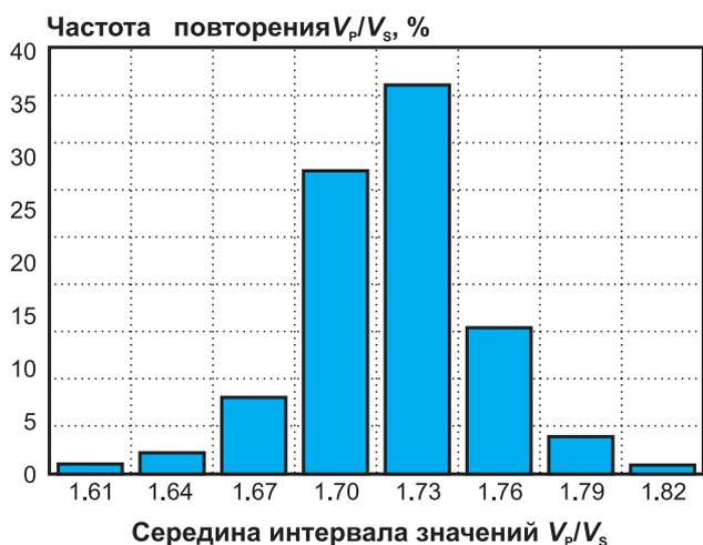
**Рис. 8.** Гистограмма частоты повторения значений  $V_p/V_s$  взрывов за 2020–2021 гг. в интервалах: 1.59–1.62, 1.62–1.65, 1.65–1.68, 1.68–1.71, 1.71–1.74, 1.74–1.77, 1.77–1.80, 1.80–1.82
