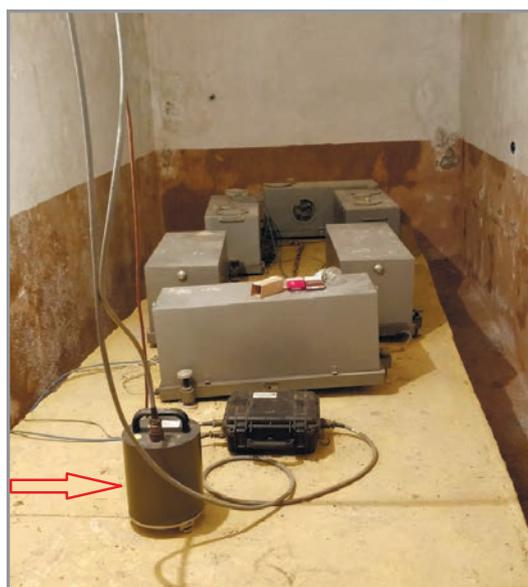
**Рис. 3.** Датчик Guralp 3EPC 60s на постаменте сейсмической станции «Ананьево» (ANVS), расположенной на севере Кыргызстана.
