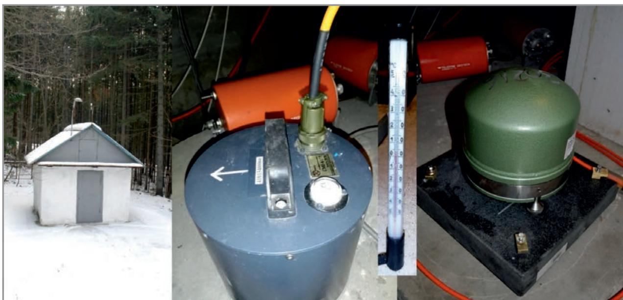
**Рис. 5.** Внешний вид сейсмотавильона сейсмической станции «Южно-Сахалинск» и размещённых в нём сейсмометров СМЕ-6111 и STS-2
