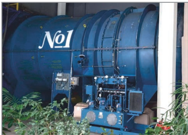
Рис. 4. Главная нагнетательная вентиляционная установка шахты «Распадская-Коксовая»
