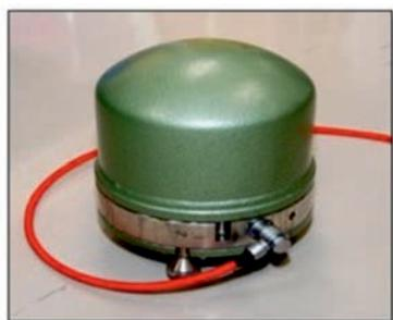
Трехкомпонентный сейсмометр STS-2
