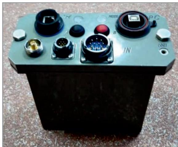
Рис. 1. Электроразведочный модуль «Байкал-512»
