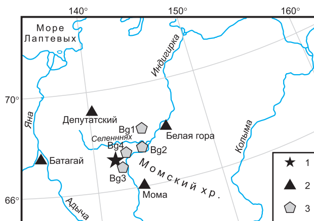
Рис. 2. Сеть стационарных и полевых цифровых сейсмических станций по наблюдению за афтершоками Илин-Тасского (Абыйского) землетрясения в марте 2013 г.
