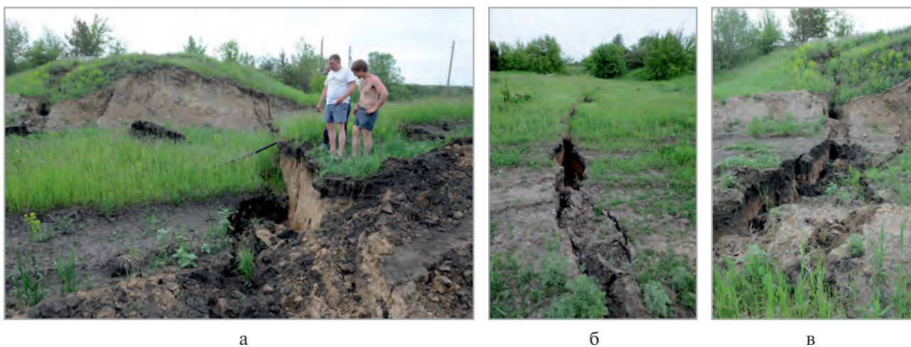
Рис. 8. Фотографии разрывов, сформировавшихся вдоль бортов угольного разреза «Бачатский» при основном толчке Бачатского землетрясения
